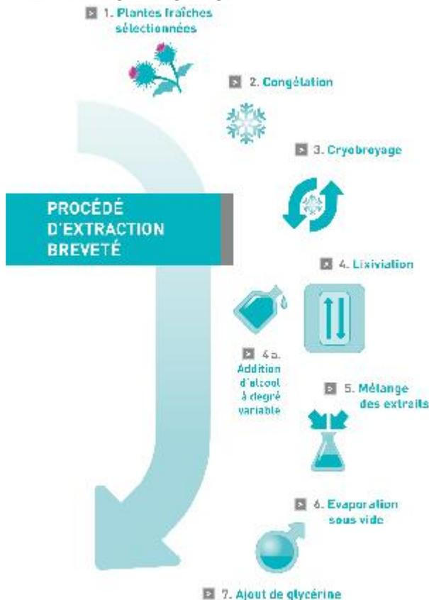
La préparation des EPS se réalise par des techniques physiques naturelles (la congélation) le froid assure la conservation de l'intégrité des principes actifs des plantes, une technique mécanique (le cryo broyage) elle facilite l'extraction de ces mêmes substances actives et un procédé physico chimique d'extraction par de l'alcool (la lixiviation).
